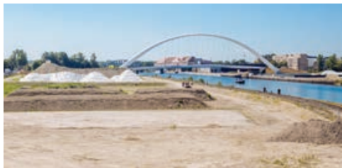
Plateformes agronomiques (premier plan) et géotechnique (deuxième plan) au nord du quartier Starlette ©Vincent Muller
